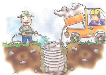
Dans le cas où **la nappe** serait plus haute que le fond de la citerne, ou en présence d'infiltration d'eau par le terrain, il est nécessaire de prévoir une isolation adéquate de la citerne.
